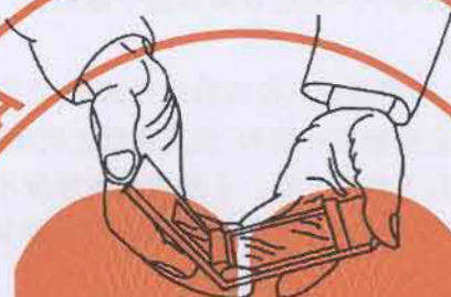
图 2 正在使用的 I型弯曲试验仪示意图
